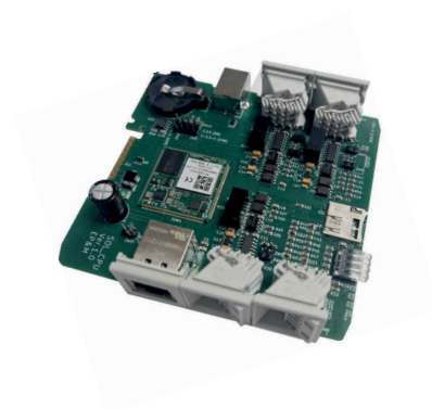
Widok kontrolera SOL CPU
